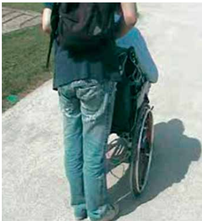
Carrozzina manuale strumentata con accelerometri e celle di carico durante le prove di acquisizione dati su strada
