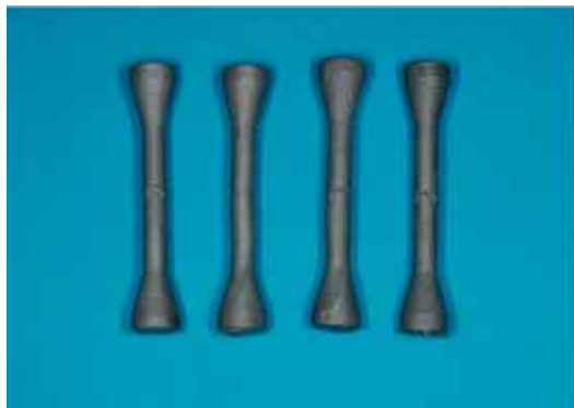
Serie di provini per prove di trazione saldati a laser
