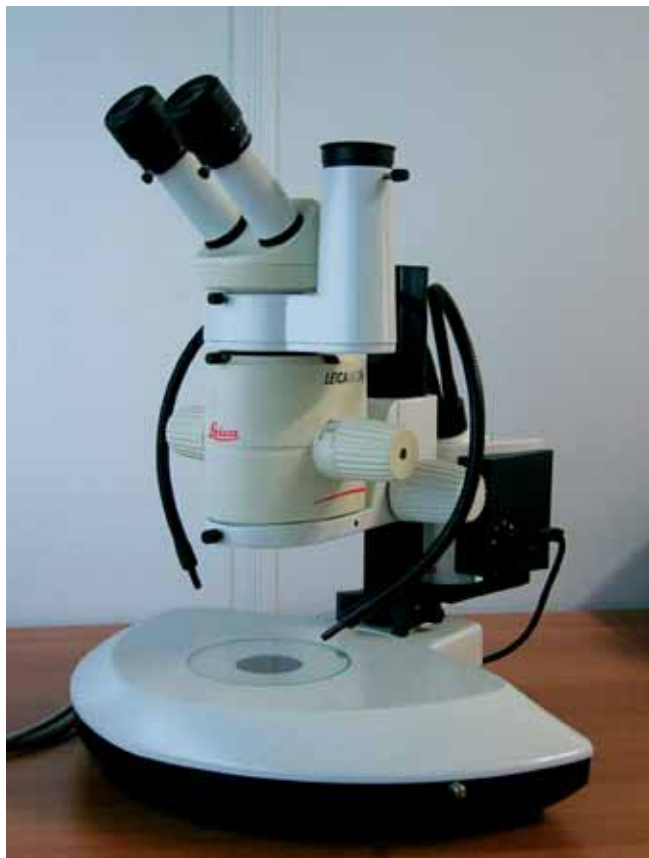
(a lato) Stereomicroscopio Leica impiegato per la misurazione dell'ampiezza del gap marginale
