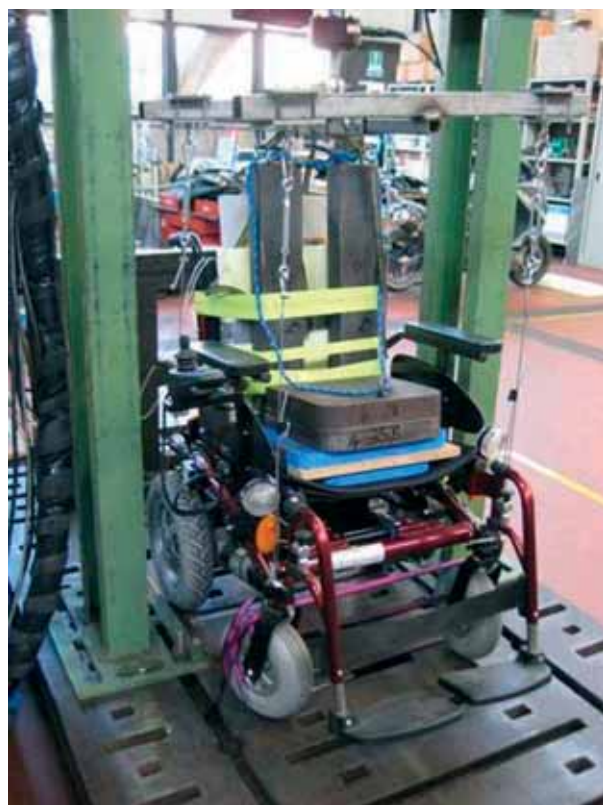
Laboratorio presso il DII, Università di Padova. Banco di caduta per prove tipo Drop Test ISO.
