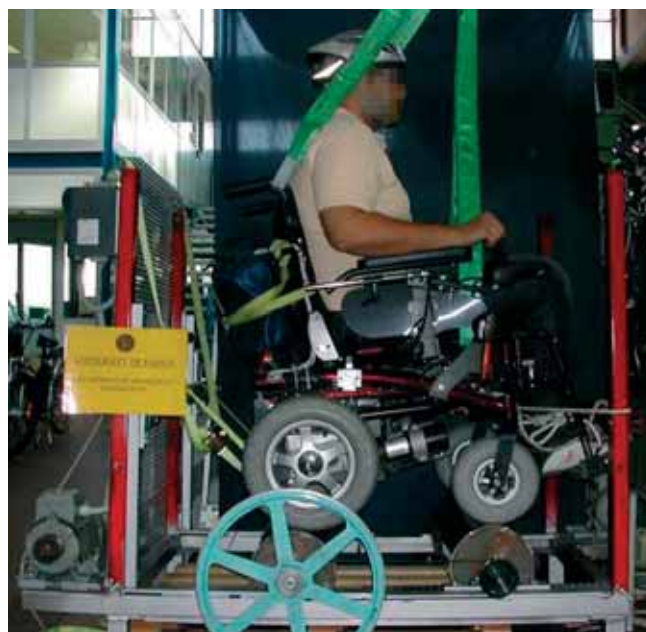
Laboratorio presso il DII, Università di Padova. Banco a rulli per prove di durata (drum tests).
