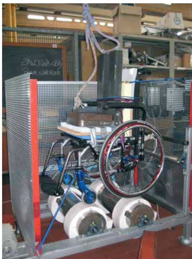
Laboratorio presso il DII, Università di Padova. Banco a rulli modificato con camme sincrone per prove di caduta simulata su banco a rulli
