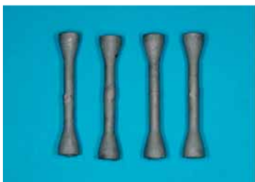
Serie di provini per prove di trazione saldati tramite brasatura
