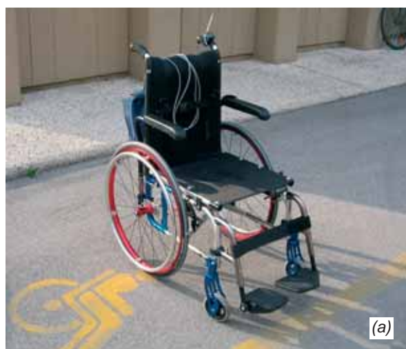
Carrozzina manuale strumentata (a) Vista di insieme della carrozzina sensorizzata. (b) Dettaglio del perno ruota strumentato
