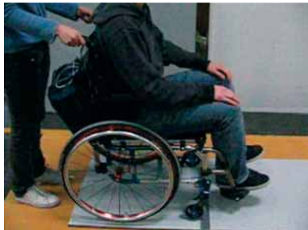
Esempio di prova di discesa da gradino su carrozzina strumentata con accelerometri all'asse anteriore e celle di carico all'asse posteriore.
