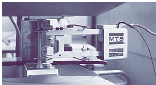
□ Figura 16 Dispositivo di prova: estensometro
