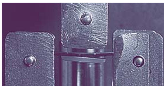
□ Figura 30 Provini portati al distacco, al termine della prova
