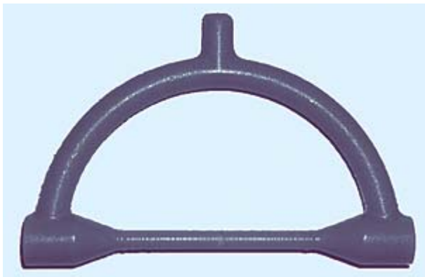
❑ Figura 9 Modello in cera della fusione da realizzare (con il canale di colata)
