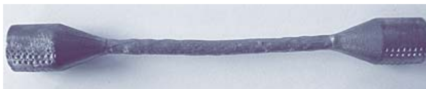
❑ Figura 18 Esempio di provino non portato a rottura: l'interruzione della prova è avvenuta per il superamento dei limiti imposti
