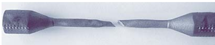
❑ Figura 17 Esempio di un provino portato a rottura
