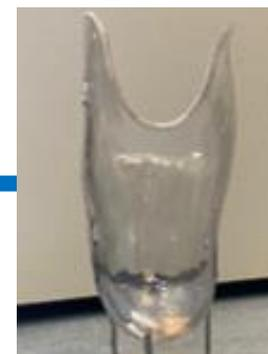
*Invasatura di prova*
