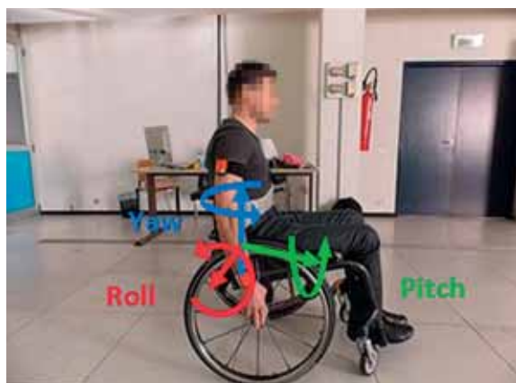
Figura 39. Rappresentazione rotazioni di Roll, Pitch e Yaw
