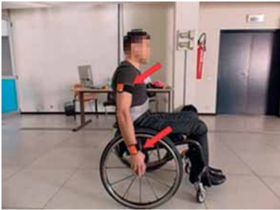
a sinistra: Figura 35. Applicazione sensori Xsens, vista laterale a destra: Figura 36. Applicazione sensori Xsens, vista posteriore
