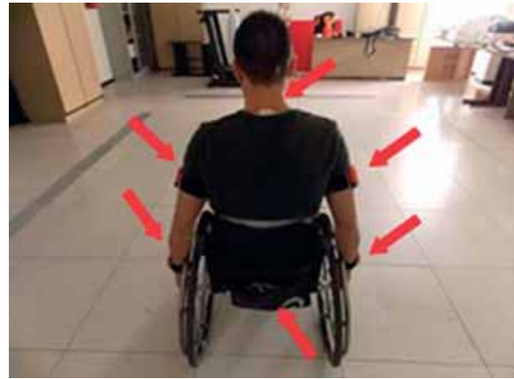
a sinistra: Figura 35. Applicazione sensori Xsens, vista laterale a destra: Figura 36. Applicazione sensori Xsens, vista posteriore
