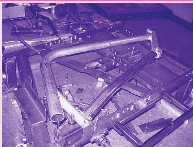
Saldatura: sul telaio puntato vengono completati i cordoni continui.
