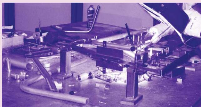
Si ottiene il telaio finito, a cui sono collegate anche staffe e blocchetti per il collegamento degli assi ruota o ausiliari.
