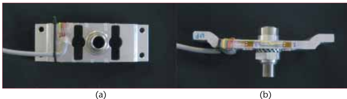
Fig. 6. Sensori di carico all'asse ruota sviluppati. (a) Vista frontale. (b) Vista superiore.
