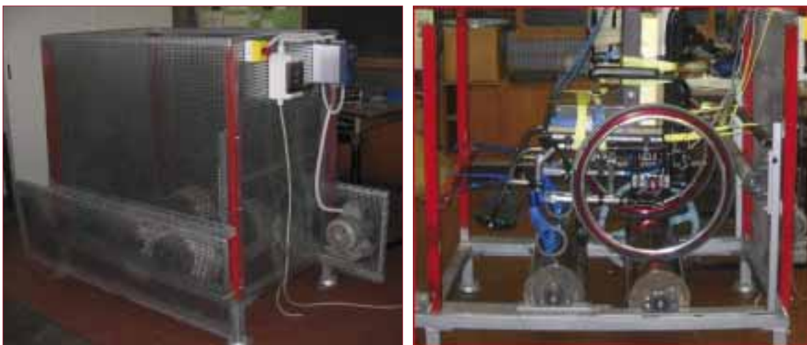
Fig. 2. Banco prova a rulli con camme per la simulazione di un gradino di 50 mm. (a) Banco con protezioni. (b) Vista laterale di carrozzina R2 con manichino di 112 kg in prova.
