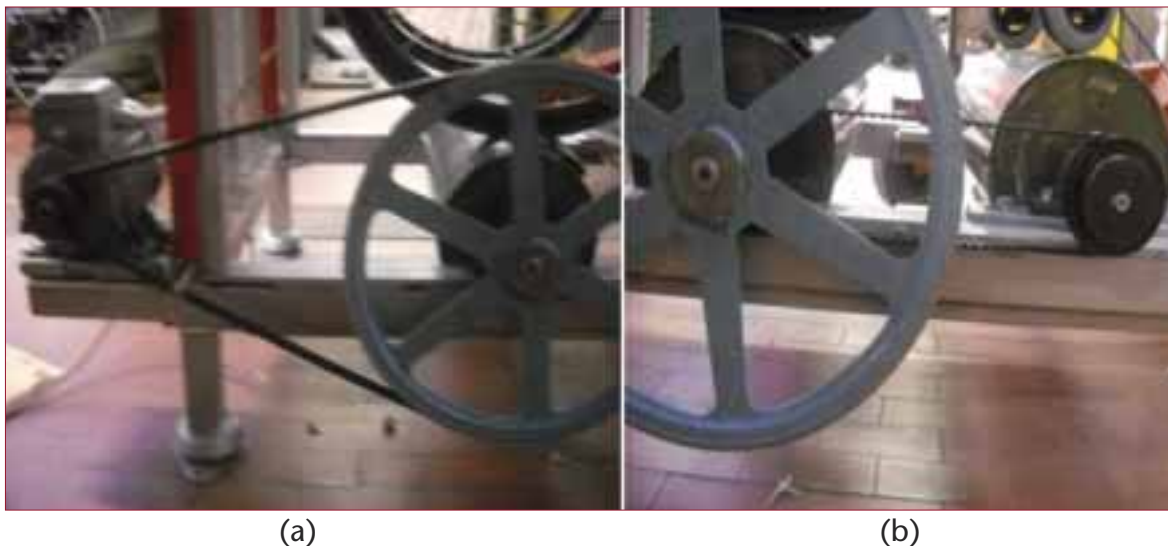
Fig. 4. Trasmissione. (a) Cinghia trapezoidale di comando del rullo posteriore di riferimento. (b) Cinghia dentata di comando del rullo anteriore.
