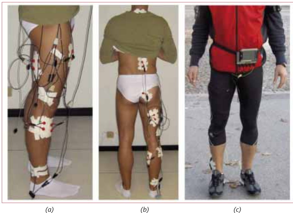
Fig.52. Applicazione degli elettrodi e degli elettrogoniometri (a e b); Soggetto pronto per l'esecuzione delle prove (c).
