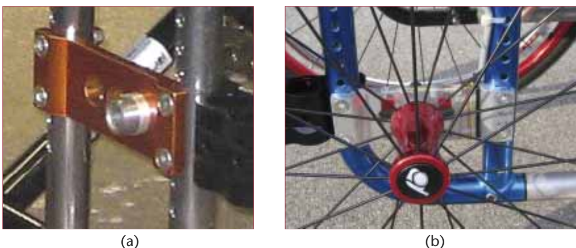
Fig. 5. Sensori di carico applicati alla carrozzina R2. (a) Piastra di supporto asse ruota di serie. (b) Piastra dinamometrica applicata alla carrozzina.
