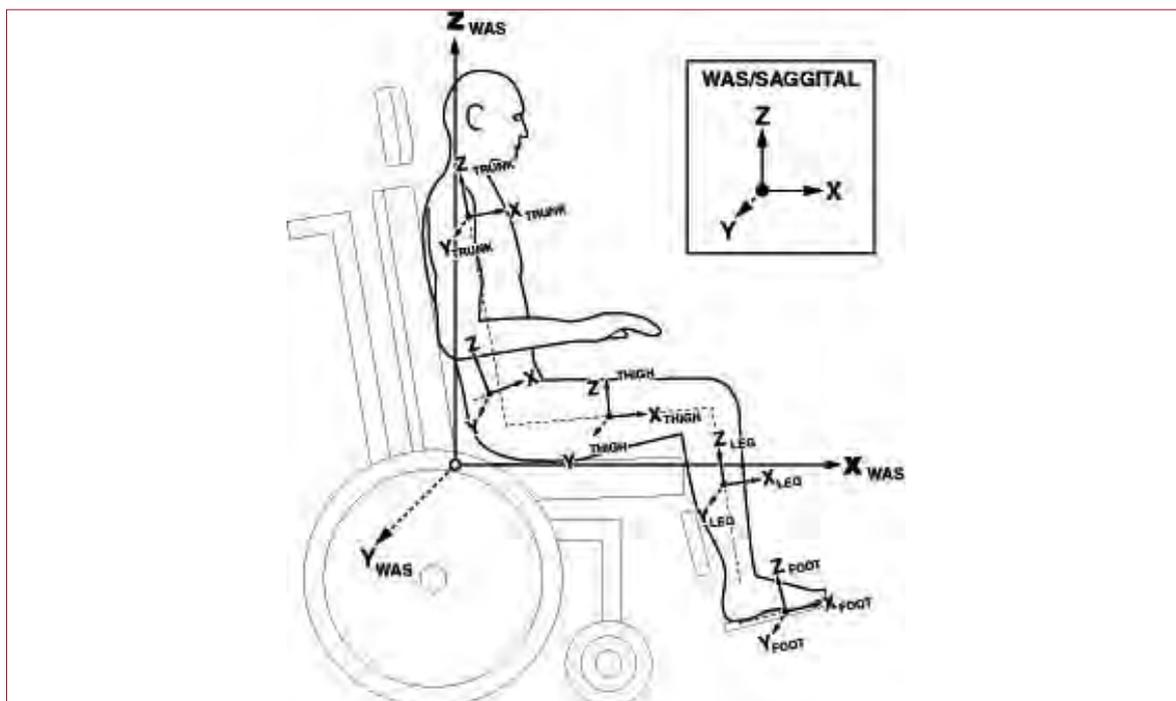
Fig. 33. Sistemi di riferimento Locali solidali ai segmenti corporei, confrontati con il Sistema di Assi della Carrozzina (WAS) centrato sul sedile.
