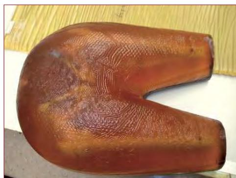
Fig. 42. Esempio di simulacro di coscia/natiche umane realizzato in gel silicico e con scheletro interno realistico (in resina) a simulare bacino e femori, utilizzato in prove pilota per la caratterizzazione delle sedute. (Univ. di Pittsburgh).
