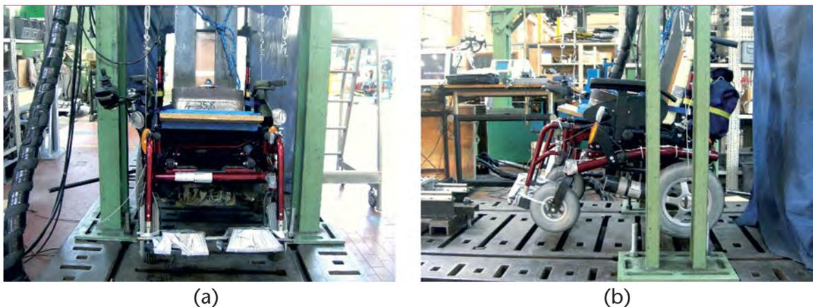
Fig. 17. Prove su Banco di Caduta con carrozzina strumentata e manichino di 124 kg (DP). (a) Vista frontale. (b) Vista laterale.
