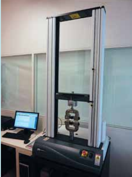
Fig. 1 - Moderna macchina universale per prove sui materiali, in uso dell'AIMAD. Con essa possono essere eseguite varie prove tra cui la trazione, la compressione, la flessione, il taglio e vari test di adesione. La macchina consente la regolazione di numerosi parametri e le prove vengono programmate tramite un computer collegato.
