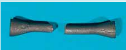
Fig. 3 - Un provino originariamente saldato tramite brasatura, dopo la prova di trazione.
