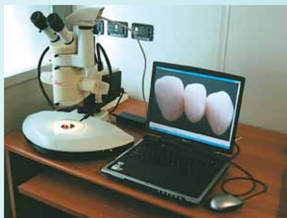
Fig. 14 - Esempio di stereomicroscopio per esami macroscopici. Lo strumento è dotato di telecamera collegata ad un computer per consentire, oltre che la visione diretta, anche la visualizzazione dell'immagine nello schermo del computer stesso.
