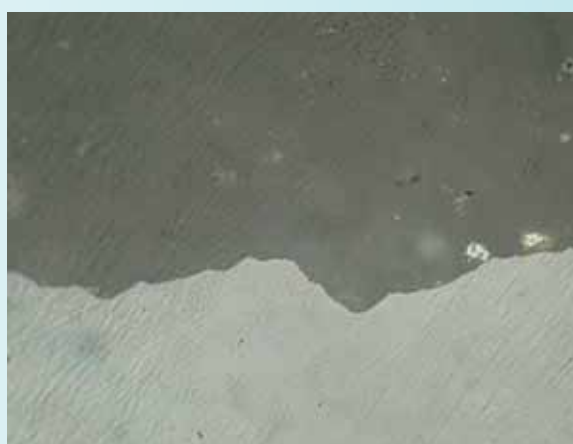
Fig. 20 - Micrografia che illustra l'ottima continuità tra la sottostruttura in zirconia (in basso) e la ceramica di ricopertura (in alto) di una protesi totalmente in ceramica.
