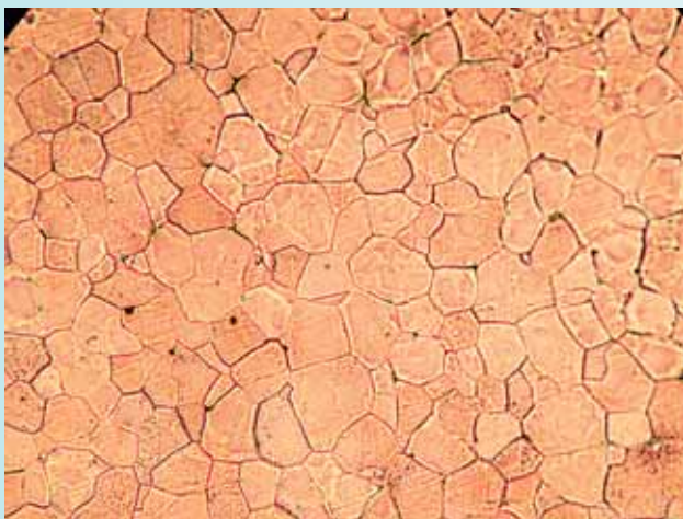
Fig. 17 - Esempio di microstruttura di una lega nobile dentale, evidenziata tramite esame microscopico.
