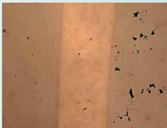
Fig. 19 - Aspetto microscopico di un giunto saldato di una lega nobile dentale, che illustra l'ottima continuità tra le superfici di unione. Sono anche visibili piccole porosità nella parte destra del metallo base.
