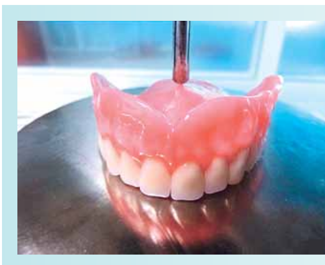
Fig. 11 - Valutazione della resistenza di una protesi totale.
