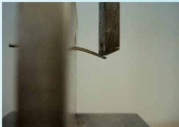
Fig. 13 - Valutazione della rigidità e della deformabilità elastica e plastica dei ganci.
