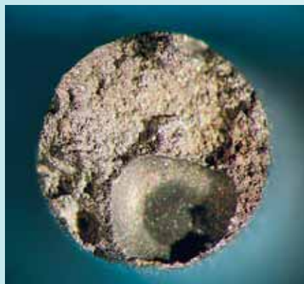
Fig. 16 - Sezione di frattura di un provino dopo la prova di trazione, che mostra la presenza di una saldatura fortemente difettosa.
