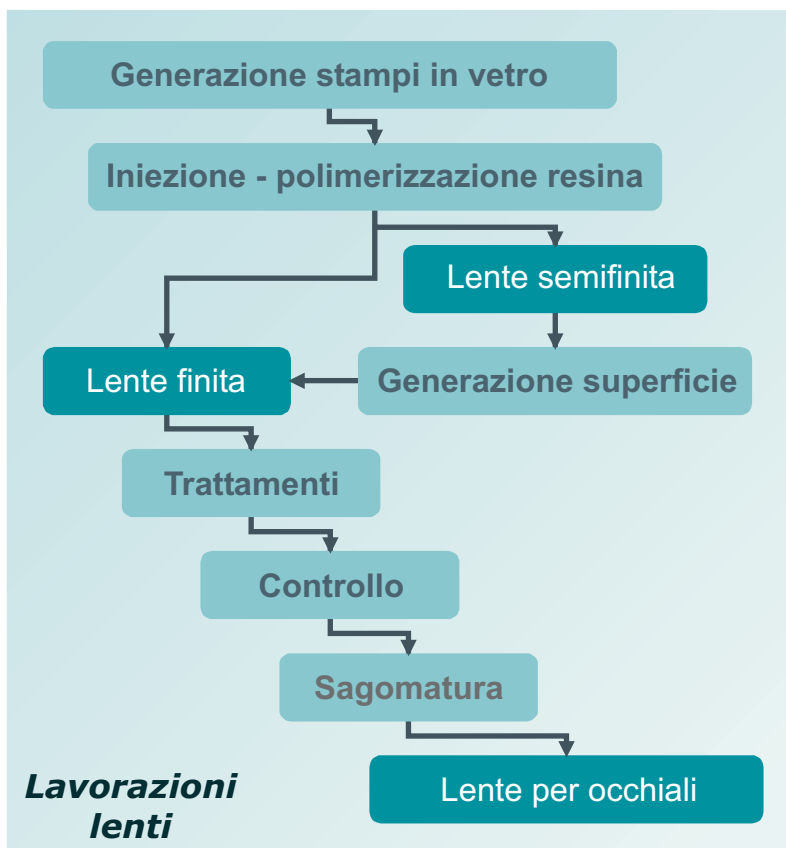
Fig. 21 - Fasi della realizzazione di una lente
